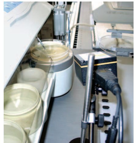
Abbildung 2: Ausplattieren einer Platte auf dem Spiralplater. Der Roboterarm hält dabei den Deckel der Platte fest.
