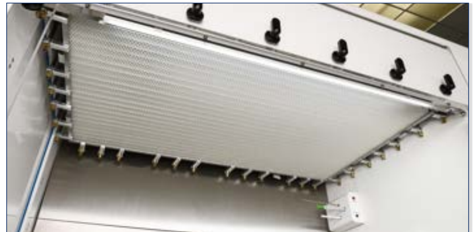
HEPA-Filter an der Kammerdecke
